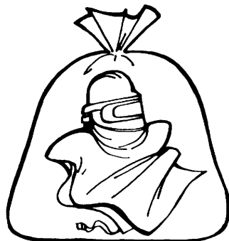
Stockez les composants du respirateur dans un endroit propre situé loin des contaminants
